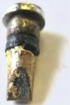
Oxidation der Lötspitze
