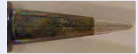
Lötspitze nach 20.000 Lötstellen mit Sn60
