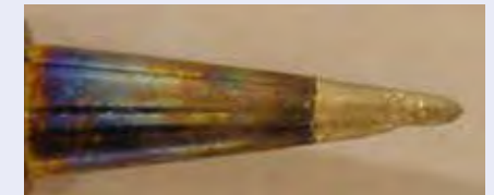
Lötspitze nach 10.000 Lötstellen mit Bleifrei SAC
