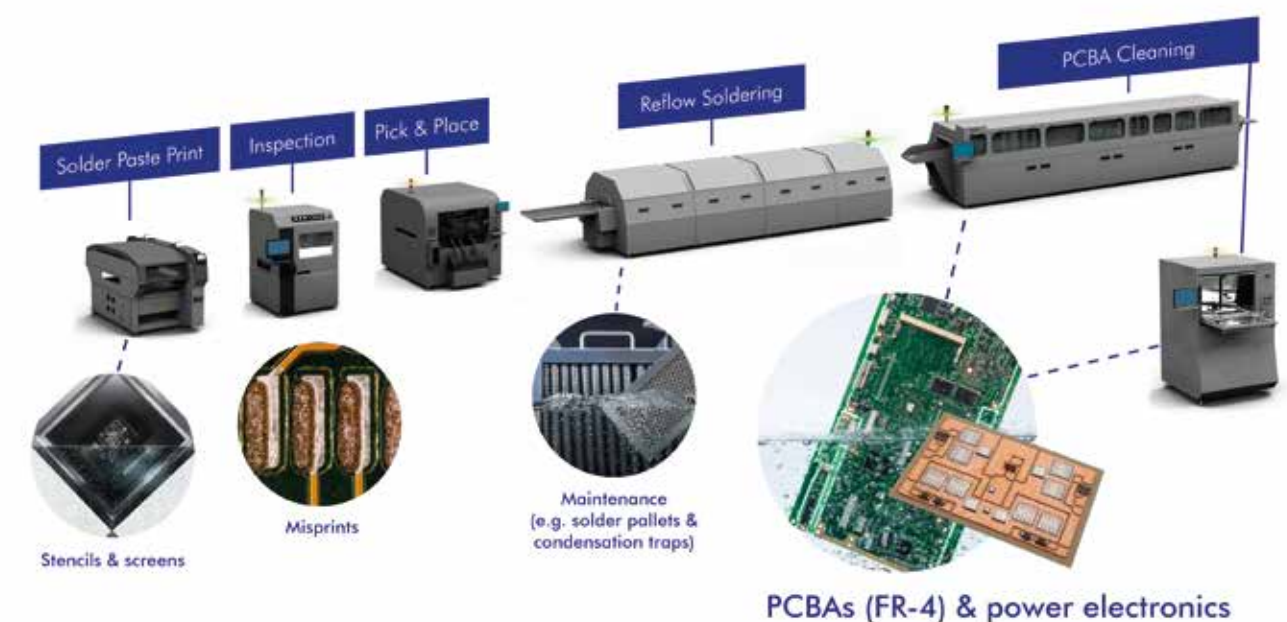
Abbildung 1: Prozesskette Bestücken und Löten von Baugruppen mit Betonung auf die Rolle der verschiedenen Reinigungsprozesse [Quelle ZESTRON] Figure 1: Process chain with printing, equipping and soldering of PCBAs with emphasis on required cleaning steps [Source ZESTRON]
