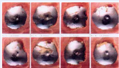
Lötunkte herkömmlicher Lötendraht mit Flussmittelseele mit Lufteinschlüssen Soldering points conventional solder wire with flux core with air pockets
