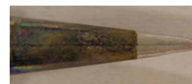
Lötpitze nach 20.000 Lötstellen mit Sn60 Soldering tip after 20,000 solder joints with Sn60
