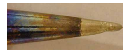
Lötpitze nach 10.000 Lötstellen mit Bleifrei SAC Soldering tip after 10,000 solder joints with lead-free SAC
