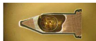
Schliffbild Lötpitze mit Lochbildung Micro-section of soldering tip with hole formation
