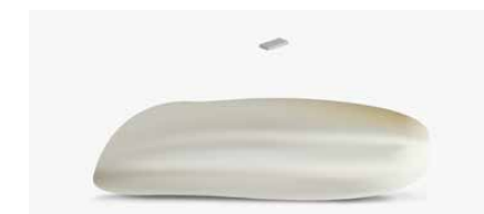
01 Größenvergleich Reiskorn/Chip-Komponente 01005 Size comparison rice grain/chip component 01005
